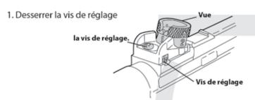
Pour déplacer la vue, tournez la vis de réglage à l'aide d'un tournevis.
