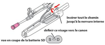
la mini batterie peut être insérée dans une direction verticale
